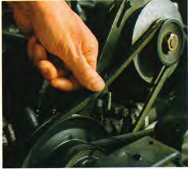
Der Keilriemen darf nicht mehr als 1,5 cm einzudrücken sein.
