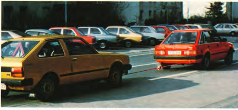
Achten Sie beim Abschleppen darauf, daß das Seil immer stramm gespannt bleibt. Am Abschleppseil ist eine rote Markierung vorgeschrieben.
