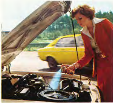
Ein wichtiger Pannenhelfer ist ein Kontaktspray. In den Verteiler gesprüht, macht es die Zündung wieder flott.
